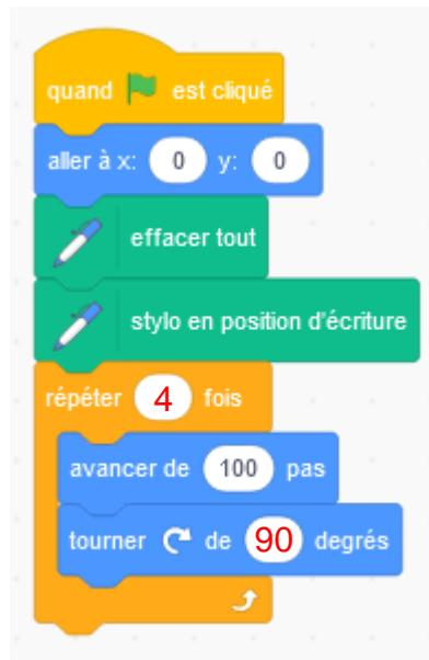
Puisqu'il s'agit d'un carré, tous les angles sont de  $90^\circ$ . Je dois donc renseigner dans le bloc « tourner de » un angle de  $180 - 90 = 90^\circ$ . Le bloc dans la boucle « répéter » permet de construire un côté du carré. Je dois donc le répéter 4 fois.
