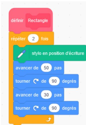
Le bloc va tracer un rectangle (il répète 2 fois le tracé d'une longueur et d'une largeur. Les angles sont bien de  $180 - 90 = 90^\circ$ ).
