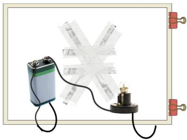
**NB : Il est important d'isoler les bandes d'aluminium avec du scotch l'une après l'autre lors de la création du montage pour éviter qu'elles ne se touchent entre elles. Sinon, l'ampoule s'allumera même si la réponse est fausse.**
