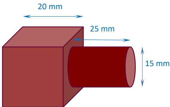
On va tout d'abord calculer le volume de la partie cubique. Ensuite, on calculera le volume de la partie cylindrique et on additionnera les deux résultats.
